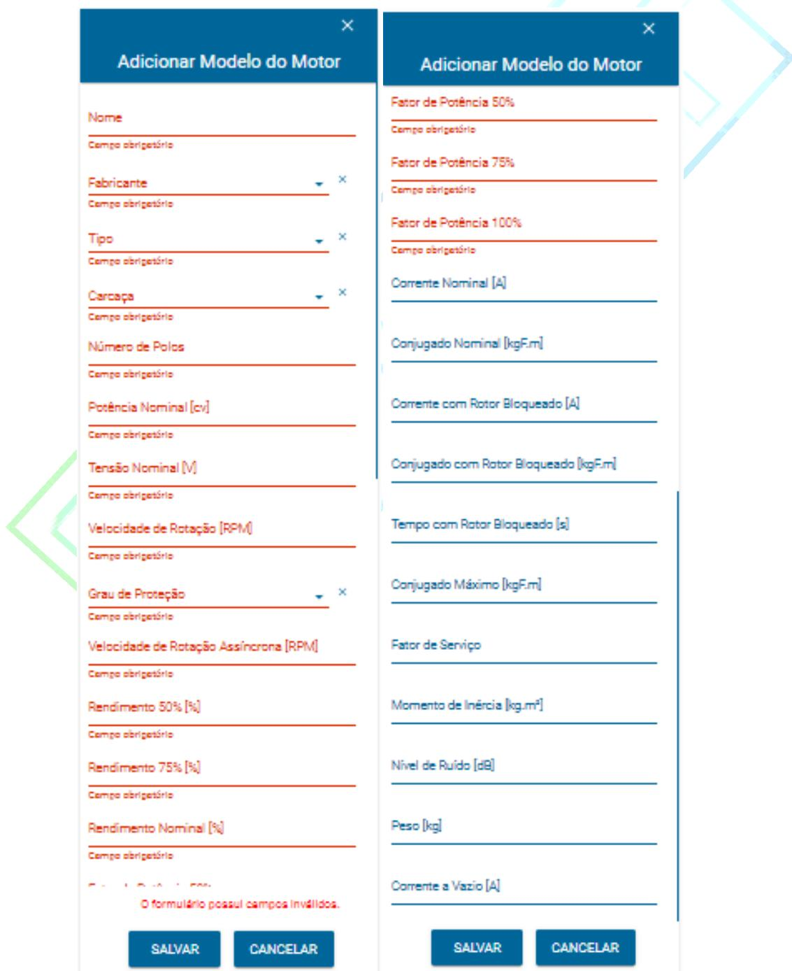
Figura 30-Aviso de Campo Obrigatório da Janela de Adição de Modelo de Motor.
