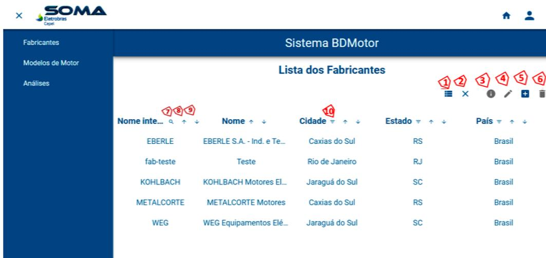
Figura 15-Janela Lista de Fabricantes com funções de indexação e Menu da janela.
